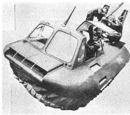
«Poduschka» heisst das kleine Luftkissenfahrzeug, das in die CSSR-Volksarmee vor einiger Zeit eingeführt wurde. Es ist 5,57 m lang, 3,17 m breit und hat eine Höhe von 2,79 m. Das von einer dreiköpfigen Besatzung bediente Fahrzeug kann als Transport- und Kontrollfahrzeug, aber auch als Waffenträger eingesetzt werden. Ein Walter-Minor-Motor von 105 PS Leistung treibt die Lüftschaube des Vortriebes an. Die «Poduschka» kann über Wasser und auf dem Land Geschwindigkeiten bis zu 110 km/h erreichen.
