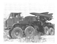
Um die Beweglichkeit der weltweit im Einsatz stehenden Improved Hawk Fliegerabwehrlenkwaffe zu verbessern, schlägt Raytheon eine auf Gelände-fahrzeugen des Typs Dragon Wagon von Lock-heed aufgebaute Version dieses Mittelstrecken-Flugkörpersystems vor. Eine solche selbstfahrende Improved Hawk Feuereinheit würde sich aus den folgenden Elementen zusammensetzen:
