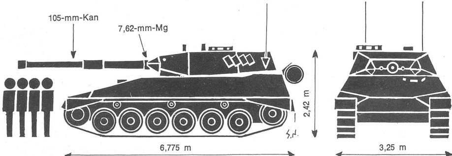
Baujahr 1977 / Gewicht 29,5 t / Motor 710 PS / Max. Geschwindigkeit 75 km/h
