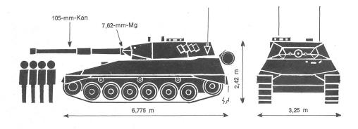
Baujahr 1977 / Gewicht 29,5 t / Motor 710 PS / Max. Geschwindigkeit 75 km/h
