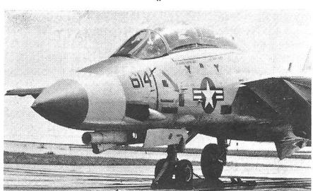
Basierend auf den mit dem elektro-optischen TISEO-Zielidentifikationssensor gesammelten Erfahrungen entwickelte Northrop eine TeleVision Sight Unit genannte neue Anlage für den Einsatz sowohl in der Luft- als auch in der Erdkampfrolle. Bei dem für eine Verwendung mit dem Mehrzweck-Schwenkfügelkampfflugzeug F-14 Tomcat ausgelegten TVSU-System handelt es sich um eine stabilisierte Fernsehkamera hoher Auflösung.
