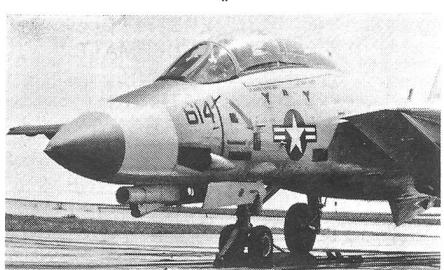
Basierend auf den mit dem elektro-optischen TISEO-Zielidentifikationssensor gesammelten Erfahrungen entwickelte Northrop eine TeleVision Sight Unit genannte neue Anlage für den Einsatz sowohl in der Luft- als auch in der Erdkampfrolle. Bei dem für eine Verwendung mit dem Mehrzweck-Schwenkflügelkampfflugzeug F-14 Tomcat ausgelegten TVSU-System handelt es sich um eine stabilisierte Fernsehkamera hoher Auflösung.
