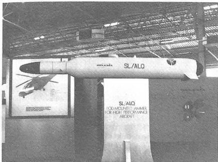
Mit dieser Anlage kann man gegnerische elektromagnetische Emissionen breitbandig erfassen und auswerten. Die aufbereiteten Signalinformationen werden daraufhin gespeichert und/oder in Echtzeit an Bedarfsträger in der Luft und am Boden übermittelt.
