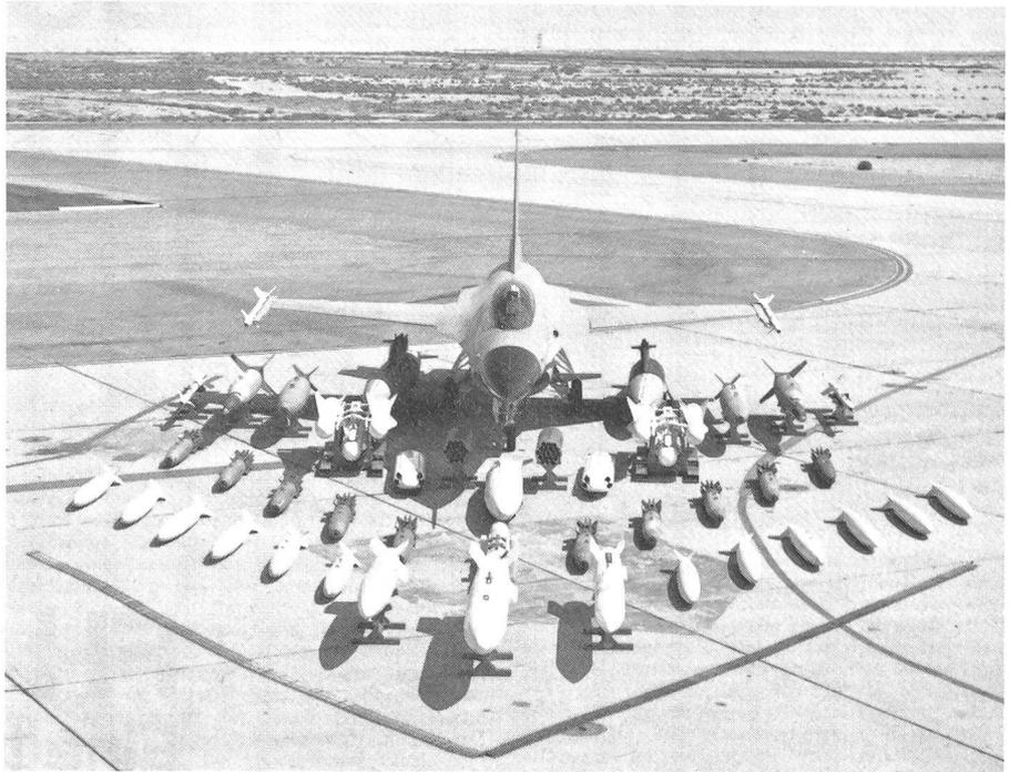
Bei vollen Treibstofftanks wird der zweirolleneinsatzfähige F-16 Luftkampffäger an neun Waffenstationen bis zu 4,75 Tonnen Kampfmittel aller Arten mitführen können. Die maximale Zuladung liegt bei rund 6,8 Tonnen. Unsere Aufnahme zeigt die in den USA für den F-16 vorgesehene fliegende und fallende Munition. Wir sehen von vorne nach hinten und von links nach rechts:
