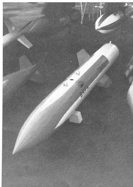
Das spanische Unternehmen Explosivos Alaveses SA fertigt eine raketenunterstützte Abwurfwanne für die Hartzielbekämpfung. Die 3,2 m lange
