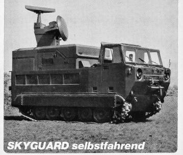
Pulsdoppler Suchradar mit autom. Zielalarm Monopulsdoppler Präzisions-Zielfolgeradar Automatisches TV-Tracking Miniaturisierter,
