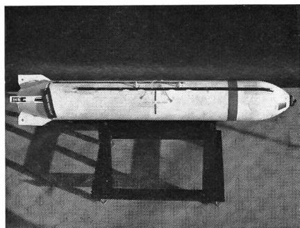
Die Streubombe Rockeye II bereit für das Anbringen an einem Unterflügellasträger eines Luftangriffsflugzeugs. In der Mitte sehen wir die beiden Schärfungsdrähte.
