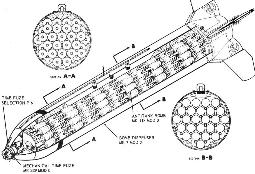
Illustration des Aufbaus der Rockeye II. Gut sichtbar ist die Lagerung der Hohlladungstochtergeschosse MK.118, Mod. O und die Anordnung der ausklappbaren Stabilisierungsfächer am Heck der Waffe. Nach dem Abwurf wird der Schüttbom- benbehälter muschelartig aufgesprengt und die Bomblets verlassen aufgrund der Wirkung der Luftströmung den Pod.
