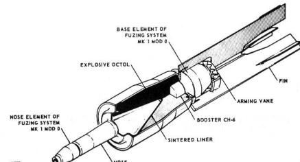
Das Hohlladungstochtergeschoss MK.118, Mod. O. Von diesen Bomblets fasst der Rockeye II Dispenser insgesamt 247 Einheiten, mit denen schätzungsweise eine Fläche von mindestens 30/50 x 100 m abgedeckt wird. (ADLG 4/76). ka
