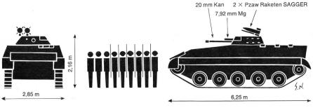
Baujahr 1975 / Gewicht 12 t / Motor (Diesel) 280 PS / Max. Geschw. 70 km/h (Land), 8 km/h (Wasser)
