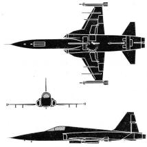
2 Düsentriebwerke / 2 Kan 20 mm / Spannweite 8,15 m / ab 1979 auch in der Schweiz / V max 1700 km/h / Länge 14,70 m /
