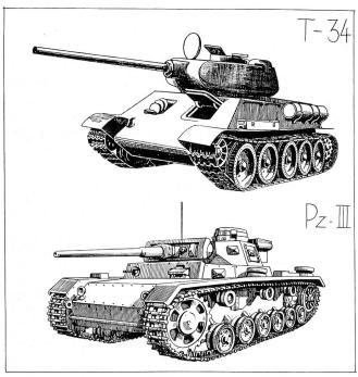
Bild oben: Russischer mittlerer Kampfpanzer T 34. Gewicht 30 Tonnen, Länge 6 m, Breite 3 m, Höhe 2,7 m, Fahrbereich 250 km, Geschwindigkeit 45 km/h, Besatzung 4 Mann, Panzerung Turmfront 75 bis 100 mm, Bug 45 bis 60 mm, Seite und Heck 45 mm, Bewaffnung 1 Kanone 7,6 cm, 2 Mg.
