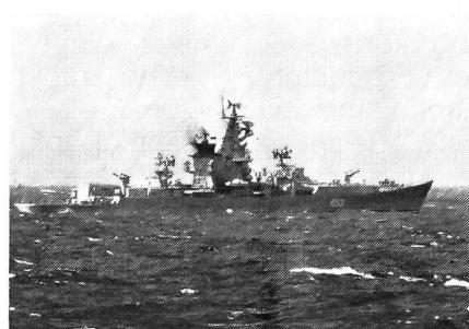
Ein «Kresta-II»-Raketenkreuzer auf Marsch im Mittelmeer. Auffällig ist die verhältnismässig flache Schiffssilhouette mit Ausnahme des massiven Kombinierten Radar- und Schornsteinmastes. Am Heck ist der Hubschrauberhangar gut sichtbar. Vorne und achtern stehen die leeren Boden-Luft-Lenkwaffenstarters.
