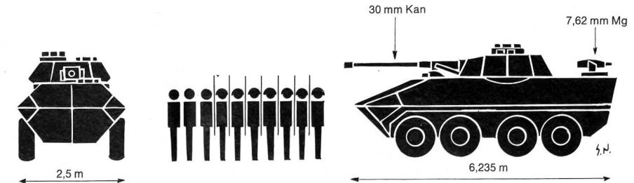
Baujahr 1973/1975 / Gewicht 12,5 t / Motor (Diesel) 325 PS / Max. Geschwindigkeit 100 km/h (Land), 10 km/h (Wasser)
