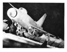
Westen muss mit dem Einsatz des SU-9 als Luftangriffsflugzeug gerechnet werden. Unser Foto zeigt einen Fishpot-B aufgenommen irgendwo in der Sowjetunion. Gut sichtbar sind die vier Flügelstationen sowie zwei abwerfbare 600 Liter Brennstoffzusatztanks an den Unterrumpfträgern.
