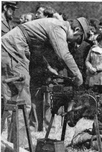
Das Hufeisen erhält den letzten Schliff mit der Feile.
