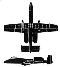
2 Düsentriebwerke / V max über 800 km/h / Über 8000 kg Kampfzuladung / 1 mehrläufige Kanone 30 mm Spannweite 16,75 m / Länge 16 m / Nur USA
