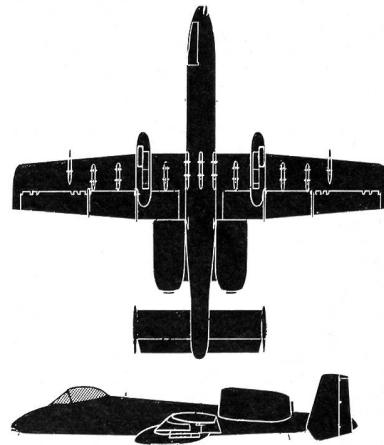
2 Düsentriebwerke / V max über 800 km/h / Über 8000 kg Kampfzuladung / 1 mehrläufige Kanone 30 mm Spannweite 16,75 m / Länge 16 m / Nur USA
