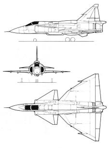
Flygvapnet/Saab Scania Einsitziges Allwetter-Jagdflugzeug mit sekundärer Eignung für den taktischen Erdkampfeinsatz JA37 Viggen (ADLG 11/75) ka
