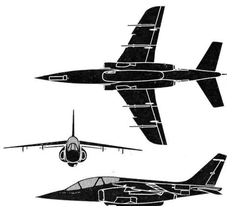
2 Düsentriebwerke von 1350 kp / V max. 1000 km/h / 1 Kan 30 mm / Spannweite 9,15 m / Länge 12,05 m
