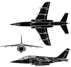
2 Düsentriebwerke von 1350 kp / V max. 1000 km/h / 1 Kan 30 mm / Spannweite 9,15 m / Länge 12,05 m In Frankreich als Trainer und in der BRD als Jagdbomber eingesetzt.
