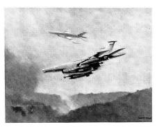
Um den Anforderungen eines westeuropäischen Gefechtsfeldes zu genügen, gab die USAF gestützt auf ihre Erfahrungen mit dem BGM-34B Fernlenkflugzeug bei Teledyne Ryan acht Einheiten eines neuen Remotely Piloted Vehicle in Auftrag. Die amerikanische Luftwaffe hat einen Bedarf von 50 dieser BGM-34C genannten Flugkörper angemeldet. Das rund 2,7 t schwere RPV wird dank einer modularen Nasensektion drei Kampfaufträge übernehmen können:
