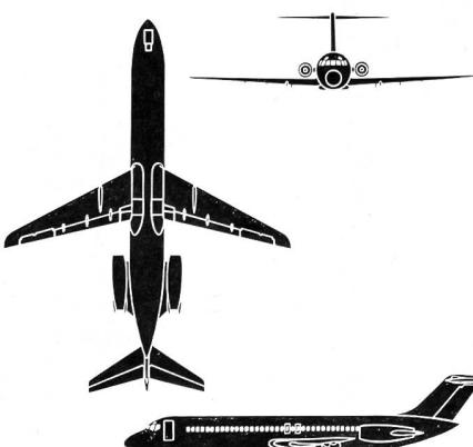
2 Düsentriebwerke von je 6570 kp / Bis 93 Passagiere / Reisegeschwindigkeit 850 km/h / Auch bei der Swissair eingesetzt / Spannweite 28,50 m / Länge 36,40 m
