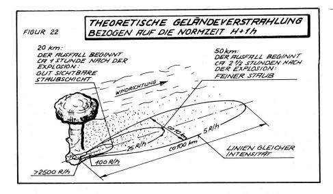
gestellt werden. Zu diesem Zweck verfügt jede Einheit über das «Spürgerät EMB 3» (siehe auch Figur 14). Nach dem Eintreffen im Abwehrdispositiv richten die Einheiten sogenannte A-Messposten ein und bereiten die A-Aufklärung vor. Periodisch wird an festgelegten Orten die Radioaktivität in Röntgen pro Stunde gemessen.
