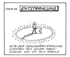
Das Abgraben der obersten Erdschicht bei Waffenstellungen schützt vor der ständigen Verunreinigung mit verstrahlter Erde. Die aus der Umgebung einfallende Strahlung wird dadurch jedoch kaum reduziert.
