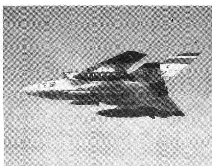
Als erster MRCA/Panavia 200 Prototyp hat die Maschine 02 die Flugerprobung mit Aussenlasten aufgenommen. Unser Foto zeigt den entsprechenden Apparat mit zwei abwerbaren Brennstoffzusatztanks an den Flügelstationen und vier 454 kg Mehrzweckbomben an den Rumpfträgern. Das trinationale MRCA-Flugerprobungsprogramm
