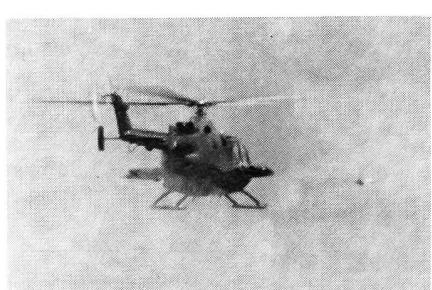
Abschuss einer schweren drahtgesteuerten HOT-Panzerabwehrkanone der zweiten Generation ab einem leichten Mehrzweckhubschrauber BO-105. Bei einer Vorwärtsgeschwindigkeit des Trägerflugzeugs von wenigstens 180 km/h erreicht der HOT-Flugkörper eine Reichweite von 4400 m. Die 22 kg schwere Lenkwanne besitzt einen 6 kg schweren Hohlladungsgefecktskopf, der alle bekannten Fahrzeugpanzerungen glatt durchschlägt.
