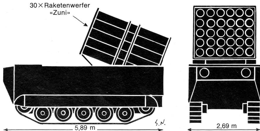
Motor (Diesel) 215 PS / Maximale Geschwindigkeit 64 km/h
