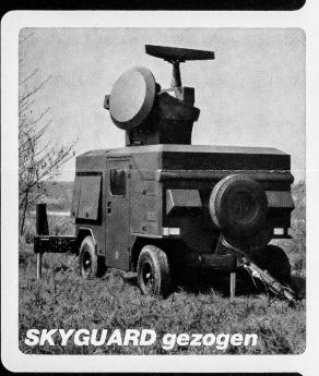
Pulsdoppler Suchradar mit autom. Zielalarm Monopulsdoppler Präzisions-Zielfolgeradar Automatisches TV-Tracking Miniaturisierter,
