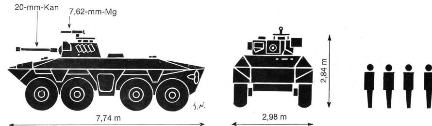
Baujahr: 1970 (Prototyp), 1975 (Serie) / Gewicht: 19,5 t / Motor (Vielstoff): 390 PS / Maximale Geschwindigkeit: 90 km/h (Land), 10 km/h (Wasser)
