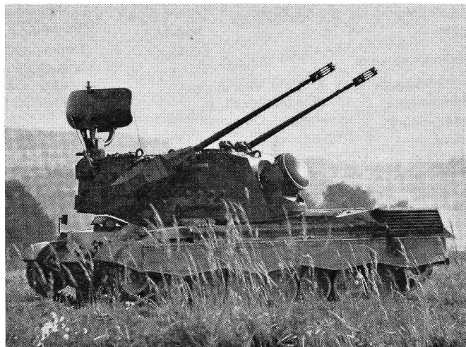
Auf grosses Interesse stiess der Oerlikon-Contraves-Flabpanzer (Typ B) für die Bundesrepublik. Im Turm des auf einem Leopard-Fahrgestell rollenden Flabpanzers befindet sich die von Contraves entwickelte Elektronik (Radar, Freund-Feind-Erkennungsanlage, Contraves-Rechner). Ausserhalb des Turmes befinden sich die beiden 35-mm-Oerlikon-Hochleistungskanonen mit einer Schusskadenz von 550 Schuss pro Minute. Die Besatzung dieses Fliegerabwehrsystems setzt sich lediglich aus drei Mann zusammen.
