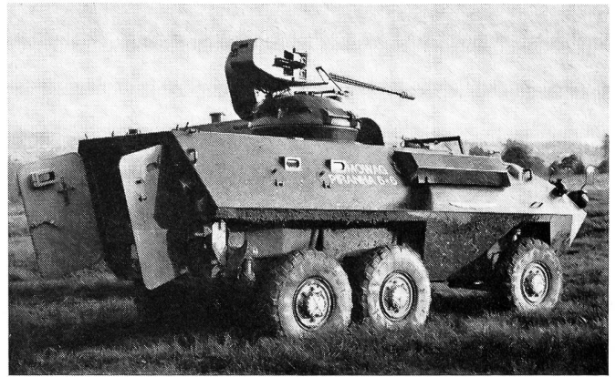
Mowag-Radpanzer Piranha 6x6, amphibisch, Bewaffnung bis 90-mm-Kanone, Raketenwerfer, Besatzung 10 Mann, Gewicht 9 t, Geschwindigkeit Strasse 100 km/h, Wasser 9 km/h.
