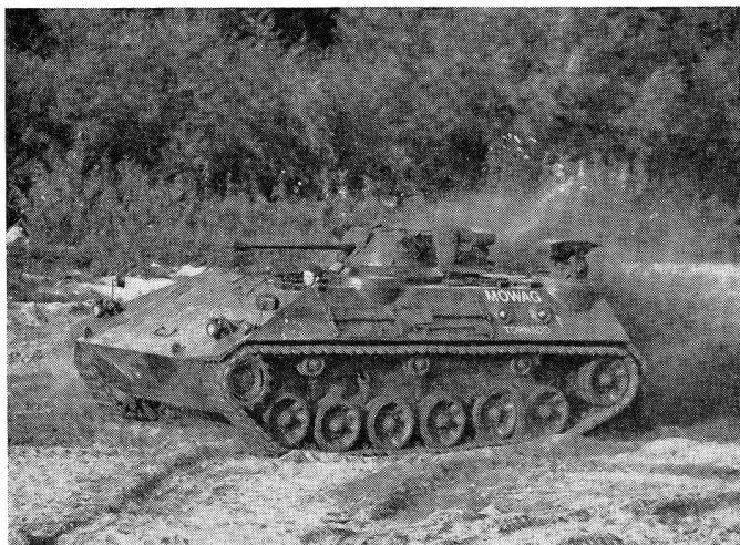
Wahrlich ein Wirbelsturm: Kampfschützenpanzer Tornado, entwickelt von der Firma Mowag. Bewaffnung bis 90-mm-Kanonen, Raketenwerfer, MW. Besatzung: 10 Mann, Gewicht: 20 t, Geschwindigkeit: 70 km/h, alle Waffen aus dem vollständig geschlossenen Fahrzeug benutzbar.
