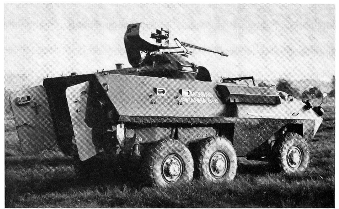
Mowag-Radpanzer Piranha 6×6, amphibisch, Bewaffnung bis 90-mm-Kanone, Raketenwerfer, Besatzung 10 Mann, Gewicht 9 t, Geschwindigkeit Strasse 100 km/h, Wasser 9 km/h.
