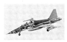
Besatzung: 2 Triebwerk: Zwei Strahltriebwerke General Electric J85-GE-21 von je 1590 kp Standschub ohne und 2270 kp mit Nachbrenner.
