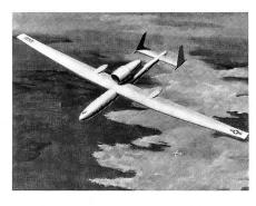
Betrieb notwendigen Komponenten sind in einem vierstrahligen Lockheed C-5A Galaxy Transporter luftverlastbar. Das von einer Strahlturbine des Typs General Electric J79-GE-100 angetriebene Remotely Piloted Vehicle von Boeing besitzt eine Länge von 12,8 m und eine Spannweite von 27,43 m. Das höchstzulässige Startgewicht liegt ka
