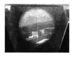
sichtfenster» erlaubt es dem Flugzeugführer, Ziele wie Brücken, Schiffe und sogar Fahrzeuge auf eine Entfernung von mehreren Kilometern einwandfrei zu identifizieren. Dem fernsehähnlichen Bild überlagert, werden in Form von Symbolen die üblichen HUD-Informationen, wie Flughöhe, Kurs, Geschwindigkeit, Zielpunkt, Bombenfallinie usw. dargestellt. Unser Foto zeigt den 24 Stunden Head-Up Display von Marconi-Elliott, wie ihn der Pilot während eines Nachteinsatzes sieht. ka
