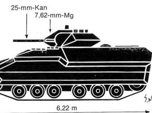
Baujahr 1975 / Motor (Diesel) 445 PS / Gewicht 18 t / Max. Geschw. 74 km/h (Land), 10 km/h (Wasser)
