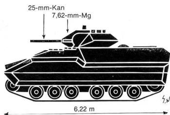
Baujahr 1975 / Motor (Diesel) 445 PS / Gewicht 18 t / Max. Geschw. 74 km/h (Land), 10 km/h (Wasser)
