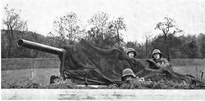
Getarnte 10,6 cm rückstossfreie Panzerabwehrkanone in Feuerstellung.
