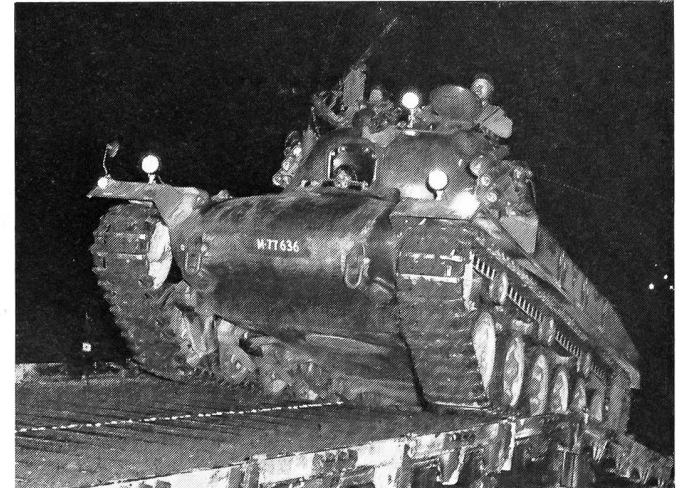
Flussübergang. Panzer 61 erklimmt die steile Rampe der Festen Brücke 69.
