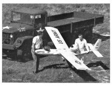
Mit Hilfe eines mit einer Fernsehkamera und einem Laserzielmarkierer ausgerüsteten Fernlenkkleinflugzeugs des Typs Praeire IIB wurde anlässlich eines weiteren erfolgreichen Copperhead-Einsatztests das zu vernichtende Objekt aus einer Höhe von 460 m angestrahlt. Der Praeire IIB Flugkörper wurde dabei von einer am Boden befindlichen Einsatzleitzentrale aus gesteuert
