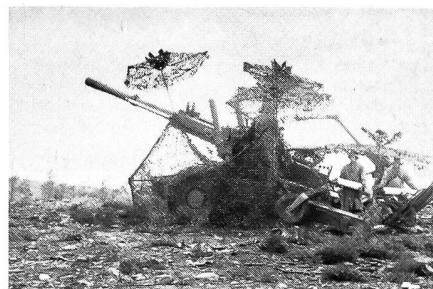
Die FH 77 in Feuerstellung unter Tarnnetz. Die Granaten werden ab Ladetisch angesetzt. Im Hintergrund ist der Hilfskran für die Munitionsbereitstellung zu erkennen. Dieses Geschütz feuert 3 Schuss in 10 Sekunden auf 22 km Schussdistanz. Mit Rak-unterstützten Geschossen werden 30 km erreicht.
