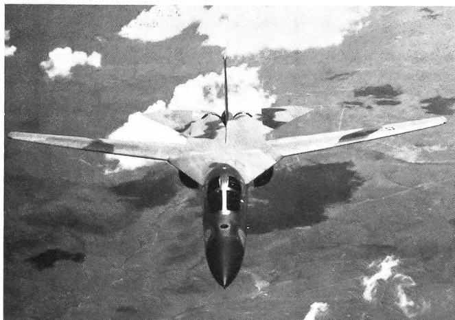
Ein eher «kleines» Flugzeug für das SAC ist der Schwenkflügelbomber FB-111. Die Maschine kann bis zu Mach 2 schnell fliegen und bei hohen Geschwindigkeiten die Tragflächen zurücklegen. Die recht hohe Traglast für Nuklearwaffen und die Luftbetankungsmöglichkeit dieser Maschine ergänzen die B-52-Flotte vorzüglich.
