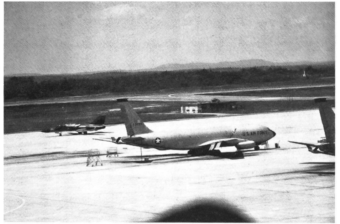
2. Juni 1975, Pease AFB. Ein FB-111-Schwenkflügel-Bomber des SAC kehrt von einer Mission zurück. Rechts sind Betankungsmaschinen K-135 mit ihren am Heck deutlich erkennbaren Betankungsstützen geparkt.
