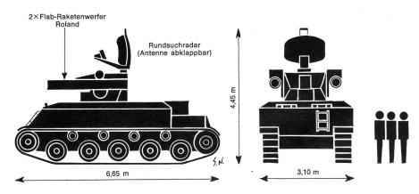
Baujahr 1975 / Gewicht 33 t / Motor 700 PS / Max. Geschw. 60 km/h / Fahrgestell AMX 30
