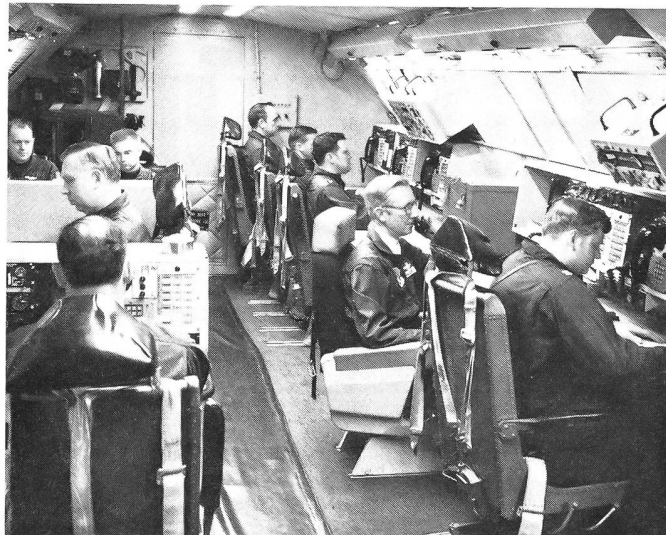
Das SAC hat jahraus, jahrein einen fliegenden Kommandoposten im Einsatz, der im Falle einer Zerstörung der Bodenorganisation eine Kontinuität der SAC-Missionen gewährleistet. Es handelt sich dabei um eine EC-135C, welche eine spezielle Version der zivilen Boeing 707 ist. An Bord ist stets ein Offizier im Generalsrang (zweiter von rechts).
