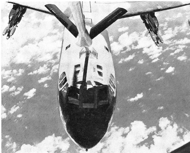
Blick aus der Luke des Betankungswarts an Bord einer KC-135 hoch über dem Pazifik. Ein strategischer Bomber B-52 hat den Kontakt zum Betankungsstutzen hergestellt. Die Aufnahme wurde anlässlich einer Bombardierungsmission über Nordvietnam gemacht. Die konventionellen Bomben sind als Aussenlasten gut sichtbar.
