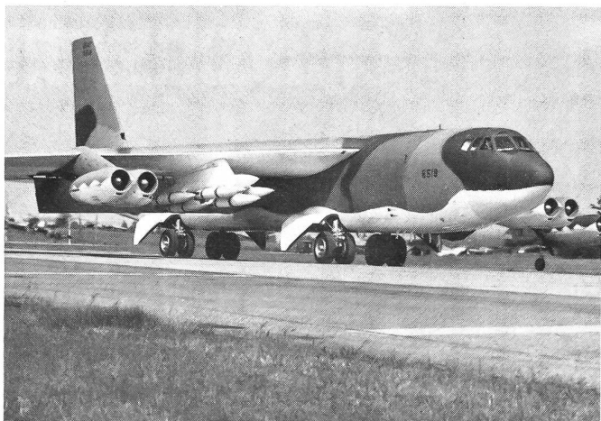
Ein B-52-Bomber im Tarnanstrich und mit SRAMs an den Aussenstationen rollt zum Start. Die riesige Maschine hat ihr Hauptfahrwerk im Rumpf, während an den äusseren Enden der Tragflächen nur kleine Stützräder ausgefahren werden können.
