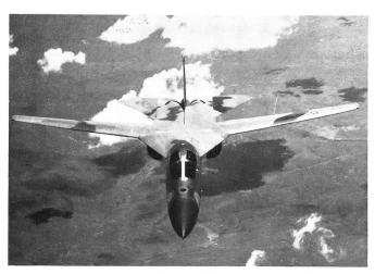
Ein eher «kleines» Flugzeug für das SAC ist der Schwenkflügelbomber FB-111. Die Maschine kann bis zu Mach 2 schnell fliegen und bei hohen Geschwindigkeiten die Tragflächen zurücklegen. Die recht hohe Traglast für Nuklearwaffen und die Luftbetankungsmöglichkeit dieser Maschine ergänzen die B-52-Flotte vorzüglich.
