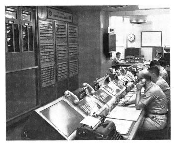
Gewaltige Computeranlagen gehören zu den weltweiten Übermittlungseinrichtungen des SAC, die in Sekundenschnelle die Verbindung zu irgendeiner Basis oder zu einem fliegenden Verband herstellen. Die abgebildete Anlage gehört zur unterirdischen Kommandozentrale des SAC-Hauptquartiers. Ganz links oben sind zwei der einzeln anrufbaren SAC-Stützpunkte erkenntlich.
