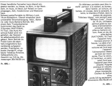
l'alimentation réseau est bien sûr incorporée. Pour la vision, à l'extérieur, un para-soleil livré avec l'appareil peut être attaché. Poignée pratique et robuste, antenne télésco-pique incorporée.
