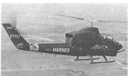
Für Lieferung im Jahre 1977 bestellte das US Marine Corps bei der Bell Helicopter Company weitere 10 AH-1 J Sea Cobra Kampfhubschrauber. Gegenwärtig verfügt dieser US-Wehrzweig über 67 dieser von einer Doppelturbine T 400-CP-400 von 1800 WPS Leistung angetriebenen Drehflügler. Die Bewaffnung der Sea Cobra setzt sich aus einer dreiläufigen 20-mm-Kanone des Typs XM-197 mit 750 Schuss Munition sowie Raketenwerfern für ungelenkte 7-cm-Raketen und MG-Pods zusammen. Hauptaufgabe ist der bewaffnete Ge-
