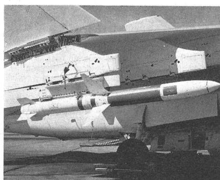
halbjahr 1974 wurden für die beiden Teilstreitkräfte insgesamt 800 Shrike-Raketen bestellt. Unser Bild zeigt eine entsprechende Lenkwaffe an der Flügelstation eines A-7 E Corsair II. Ab 1980 wird die AGM-45 A durch die zurzeit in Entwicklung befindliche AGM-88 A HARM (High Speed Anti Radiation Missile) abgelöst werden. ka
