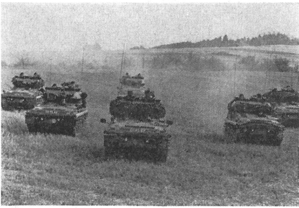
Scorpion-Spähpanzer beim Manöver im Harz. Bewaffnung: 76-mm-Kanone in Drehturm mit 360° Schwenkbereich.
