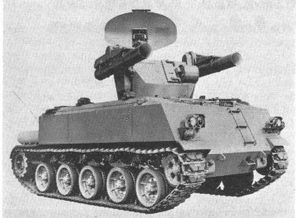
Klarwettersystem für den Einsatz unter guten Wetterbedingungen mit optischer Zielverfolgung durch den Lenkschützen. Die Führung der Lenkwaffe entlang der Visierlinie geschieht automatisch mit der Hilfe eines Kommandorechners und einer Kommandosendeanlage. Die Zielzuweisung erfolgt durch ein Rundsuch-
