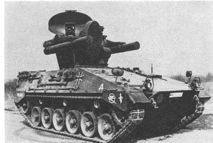
Allwettersystem für den Einsatz bei Tag, Nacht und unter schlechten Wetterbedingungen. Zielzuweisung wie beim Roland-I-System. Die Zielperfolgung hingegen erfolgt automatisch, und zwar mit der Hilfe einer zusätzlichen Lenkradaranlage. Unser Bild zeigt eine Roland-II-Anlage auf dem Chassis des Spz Marder der deutschen Bundeswehr.
