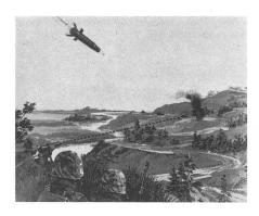
Unser Bild zeigt, wie ein vorgeschobener Artilleriebeobachter mit Hilfe eines Laserstrahls (Strichlinie) ein Artilleriegeschoss gegen ein bewegliches Ziel führt. In den USA ist ein System entwickelt worden, das es ermöglicht, mit Hilfe von Laserstrahlen auch konventionelle Artillerie mit höchster Präzision gegen feste und bewegliche Ziele einzusetzen.
