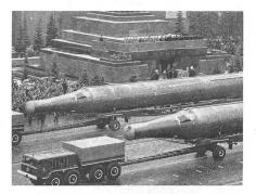
Schätzungen westlicher Geheimdienste zufolge verfügt die Sowjetunion über ca. 300 einsatzbereite interkontinentale ballistische Raketen des Typs SS-9 (Scarp). Die dreistufige, von Flüssigtreibstoffmotoren angetriebene 35 m lange Lenkwaffe besitzt einen Durchmesser von 3 m und eine Reichweite von 12 000 km. Die SS-9 (Scarp) dient vermutlich als Trägerfahrzeug für die folgenden Gefechtsladungen:
