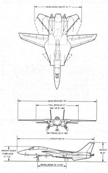
US Navy/Grummann Aerospace Corporation Zweisitziges bordgestütztes Mehrzweckkampfflug-zeug mit Schwenkflügeln. F-14A Tomcat (ADLG 5/75)
