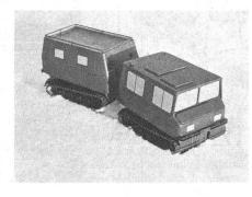
Eine neue «Generation» von Militärraupenfahrzeugen, die von Hägglund & Söner, Oernsköldsvik, an die schwedische Verteidigung geliefert werden, wird mit Karosserien und Ketten aus Kunststoff ausgestattet sein, meldet Trelleborgs Gummifabriks AB, von der die Kunststoffteile geliefert werden.
