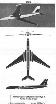
4 Düsentriebwerke Nur in der UdSSR **Ehemaliger Bomber** Länge 48 m Spannweite 52 m
