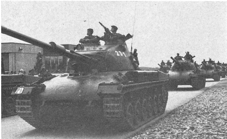
2 In Zweierkolonnen rollen unter erheblichem Lärm die noch mit ungepolsterten Ketten ausgerüsteten Panzer 61 vorbei. Sie sind mit einer 10,5-cm-Kanone und einer rohrparallelen 20-mm-Schnellfeuerkanone ausgerüstet. Auf dem Turm ist das Mg zu erkennen. Auch Panzer des neueren Typs Pz 68 wurden gezeigt.
