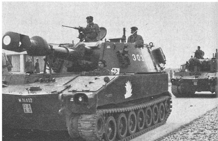
5 Das moderne Bild der Artillerie. Rekruten der Art RS 223 führen die Panzerhaubitze 66 (oder auch M 109) amerikanischen Ursprungs vor. Die Haubitze ist mit einem Rohr von 15,5 cm ausgerüstet.
