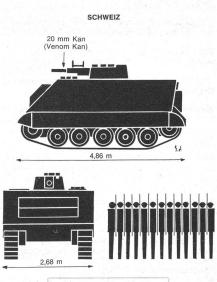
Schützenpanzer Spz 63 (mit Turm, schwimmfähig)
