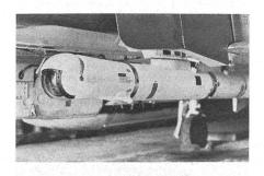
Die Einführung des neuen Laserzielbeleuchters AN/AVQ-23 Pave Spike bei den amerikanischen Luftstreitkräften hat begonnen. Das 366 cm lange Behältergerät von Westinghouse besitzt einen Durchmesser von 25,4 cm und ein Gewicht von 193 kg. Auf dem F-4 Phantom Jagdbomber wird
