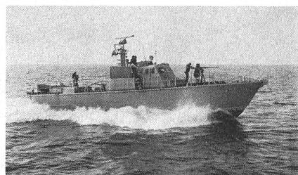
Im Februar 1975 zum erstenmal der israelischen Marine geliefert, ist «Dabur» ein Küstenboot aus Aluminium, das durch einen Dieselmotor mit zwei Propellern bei einer Geschwindigkeit von 22 Knoten angetrieben wird. Der Aktionsradius beträgt 700 Seemeilen. Es kann sowohl auf hoher See als auch an den Küsten wie auf Binnengewässern eingesetzt werden.
