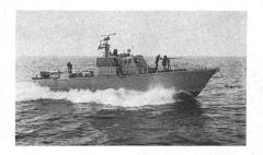
Im Februar 1975 zum erstenmal der israelischen Marine geliefert, ist «Dabur» ein Küstenboot aus Aluminium, das durch einen Dieselmotor mit zwei Propellern bei einer Geschwindigkeit von 22 Knoten angetrieben wird. Der Aktionsradius beträgt 700 Seemeilen. Es kann sowohl auf hoher See als auch an den Küsten wie auf Binnengewässern eingesetzt werden.
