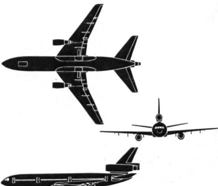
3 Düsentriebwerke      Reisegeschwindigkeit 900 km/h
