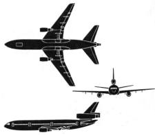
3 Düsentriebwerke 249 Passagiere (Swiss Spannweite 50.4 m Reisegeschwindigkeit 900 km/h Länge 55,5 m
