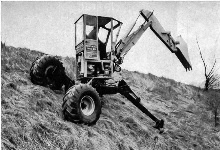
Der Bagger, der mehr leistet als die anderen, weil er nicht nur für die üblichen Baggerarbeiten eingesetzt werden kann, sondern auch im Steilhang und im Sumpf, wo bisher nur Handarbeit möglich war. Der MUCK hilft Arbeitskräfte sparen und Umläufe senken.
