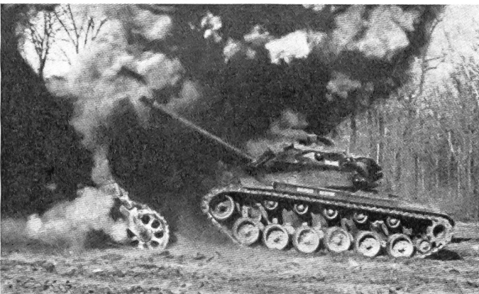
Amerikanischer Minenräump Panzer M-48. Beachte: Das Räumgerät hat soeben eine Panzermine ausgelöst.
