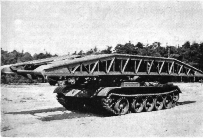
Russischer Brückenlegepanzer Typ T-54. Brückenlänge: 13 m; Brückenbreite: 3,5 m; Tragkraft der Brücke: 50 t; Gewicht des Fahrzeuges inkl. Brücke: 40 t; Bewaffnung: 1 Mg 12,7 mm.
