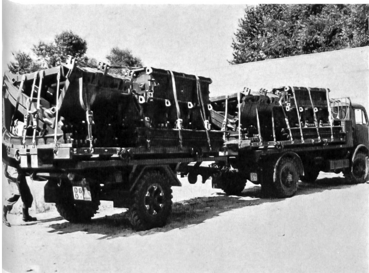
Zwei Paletten (je 3,2 t) mit Fachwerk- und Kastenelementen
