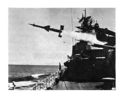
Wie bereits in ADLG 4/74 kurz berichtet, bestückt das Boden-Luft-Lenkwaffensystem SA-3 Goa auch verschiedene sowjetische Kriegsschiffe. In der Schiff-Luft-Rolle trägt diese zweistufige Rakete die Bezeichnung SA-N-1. Unsere interessante Aufnahme zeigt den Start eines Goa-Flugkörpers ab einem Doppelwerfer an Bord eines Lenkwaffenzerstörers der Kashin-Klasse. ka
