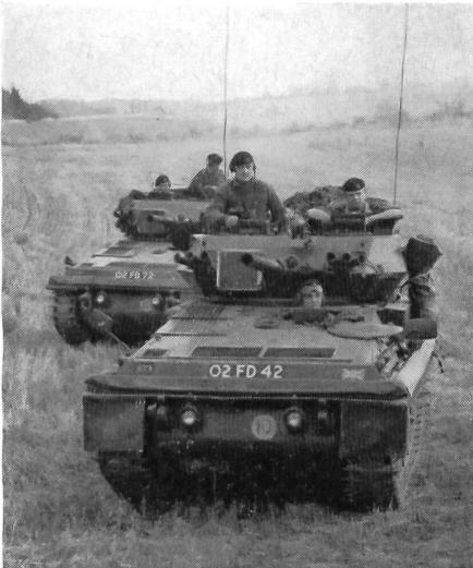
einem niedrigen Bodendruck von rund 0,34 kg/cm², einer gummigepolsterten Kette und sieben Gängen mit Fliehkraftkupplung erreicht das Fahrzeug eine überdurchschnittlich gute Geländegängigkeit. Mit Hilfe eines Balges kann der neue Gleiskettenpanzer zudem voll schwimmfähig gemacht werden. Auch hier ist er lufttransportfähig und z.B. ein Lockheed-Frachter C-130 Hercules kann zwei Scorpions tragen.
